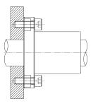
SM型線性軸承以一個C型扣環加上端蓋及螺絲,固定於孔緣。
